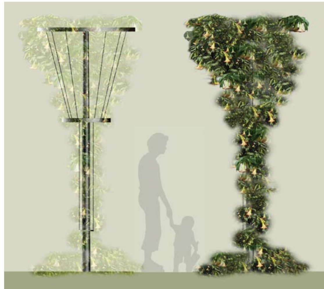
Több hazai cég összefogásával készült innovatív megoldás a Növénykandeláber, mely eredményesen egészítheti ki az utcafásítási projekteket ott, ahol a közműhálózat miatt nem lehet ültetőgödört ásni
